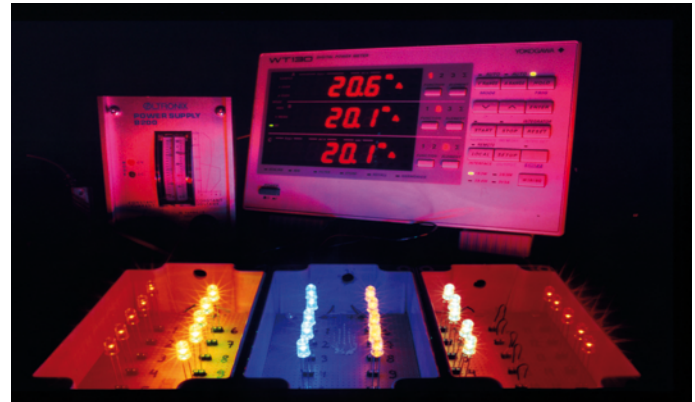
LEDit ovat itseasiassa valoa emittoivia diodeja. Kuvassa suoritetaan LEDien koepolttoa. Kuva: Jaakko Ketomäki.
